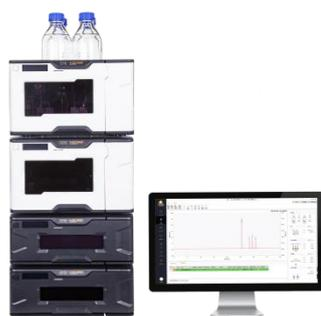
悟空 K2025 高效液相色谱仪多样化的配制满足以上方法的检测要求。
