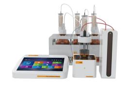
通过水分滴定仪排液装置,排除残液,加入溶剂甲醇 40mL 于滴定杯中,溶剂需要没过电极,设置好参数后,仪器开始预滴定,待仪器处于待机状态时,点击系统进样,打开加料口橡胶塞,根据样品消耗滴定液的体积选择进样量,迅速加入试样,立即盖好橡胶塞,点击开始测定,用卡尔费.休滴定剂滴定至终点,输入样品的称样量,计算样品的水分含量。
