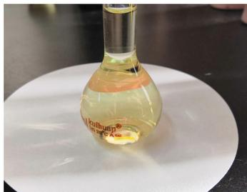
重新称取石油样品约 0.1g (精确至 0.1mg) 置于消解罐底部, 加入 6mL 硝酸和 2mL 过氧化氢, 静置 15min 左右, 组装消解罐, 按照如下设置参数进行消解实验:
